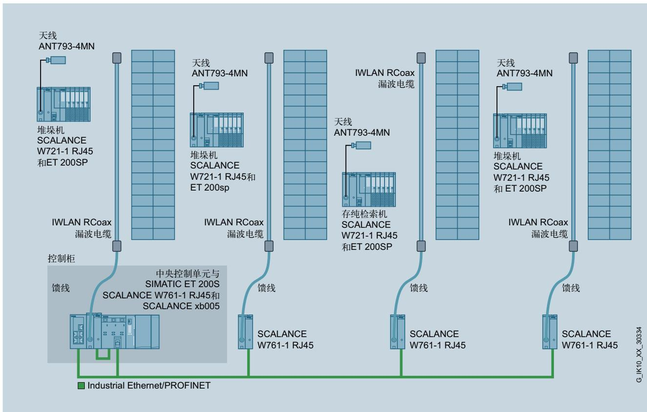
应用案例：堆垛机在立体仓库中应用SCALANCE W721-1 RJ45 和 W761-1 RJ45以及Rcoax漏波电缆
